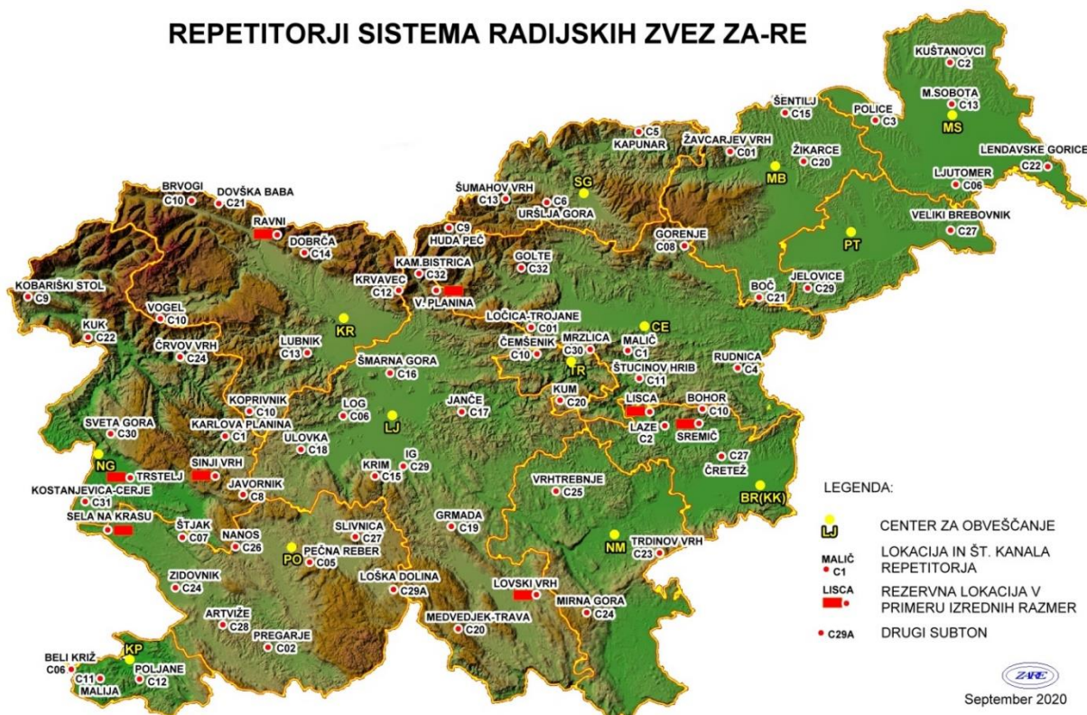
Slika 4: Repetitorske postaje s kanali sistema ZA-RE
